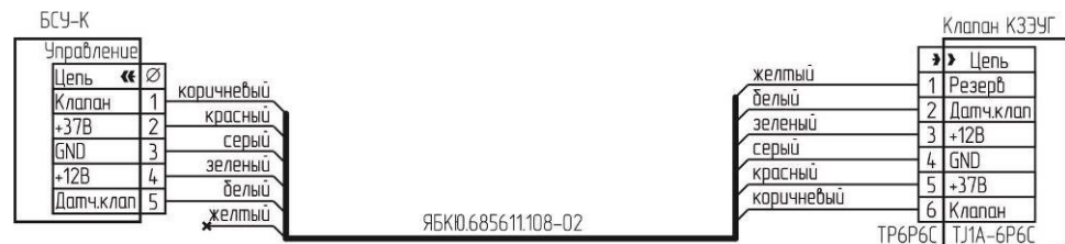
Рисунок В.6 – Схема подключения клапана К3ЭУГ с разъемом TJ1A-6P6C.
