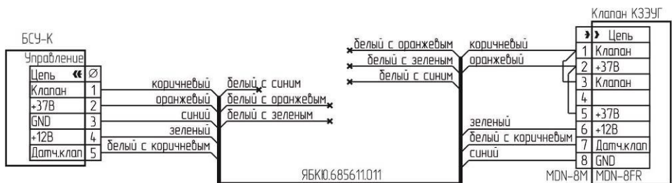
Рисунок В.5 – Схема подключения клапана К3ЭУГ с разъемом MDN8FR.
