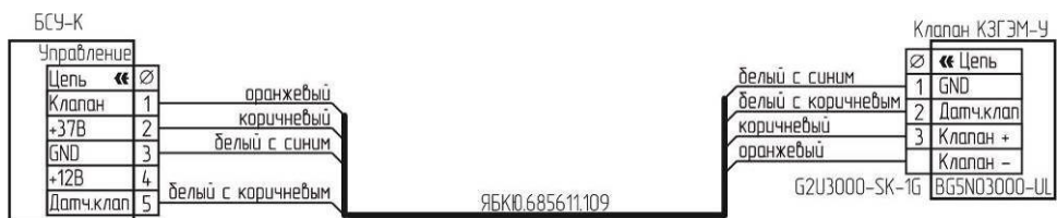
Рисунок В.4 – Схема подключения клапана К3ГЭМ-У с разъемом BG5NO3000-UL. Установить S3.7(тип клапана) OFF - «К3ГЭМ-У, К3ЭУГ»
