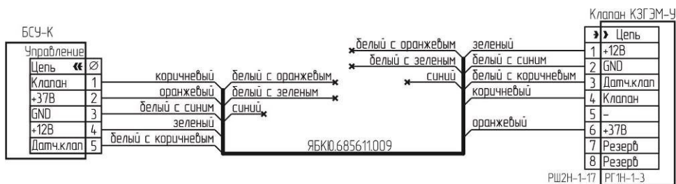
Рисунок В.3 – Схема подключения клапана К3ГЭМ-У с разъемом РГ1Н-1-3. Установить S3.7(тип клапана) ON - «Другой»
