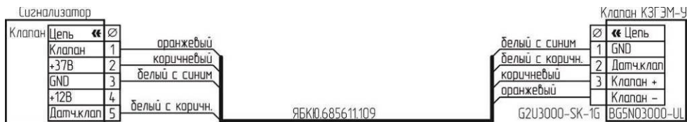
Рисунок В.3 – Схема подключения клапана К3ГЭМ-У с разъемом BG5NO3000-UL.
