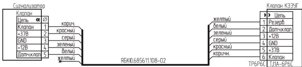
Рисунок В.4 – Схема подключения клапана К3ЭУГ с разъемом TJ1A-6P6C
