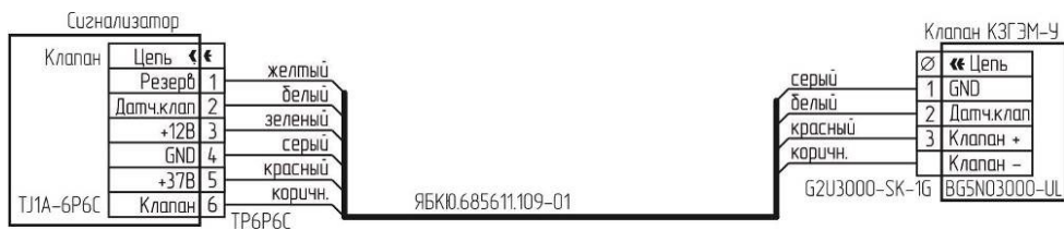
Рисунок В.1 – Маркировка кабеля с разъемом G2U3000-SK-1G для клапана КЗГЭМ-У
