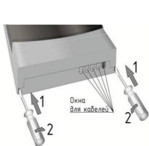
Рисунок 2 – Снятие крышки клеммного отсека
