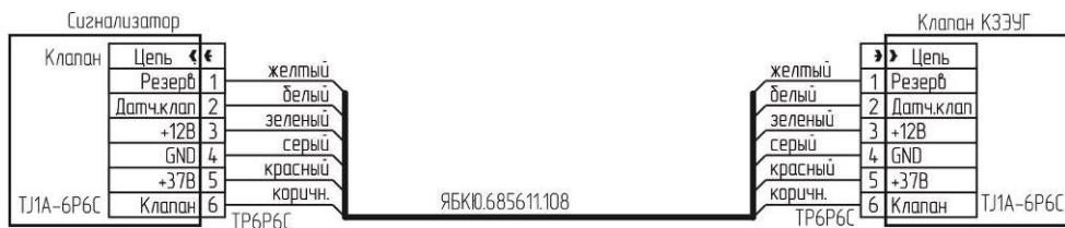
Рисунок В.2 – Маркировка кабеля с разъемом TR6P6C для клапана КЗЭУГ.
