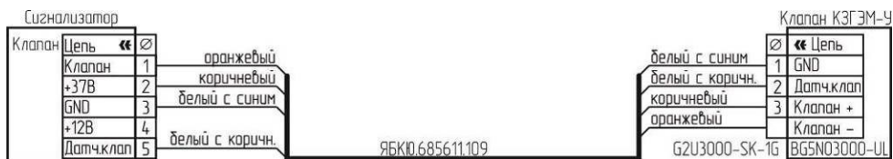
Рисунок В.3 – Схема подключения клапана КЗГЭМ-У с разъемом BG5NO3000-UL.
