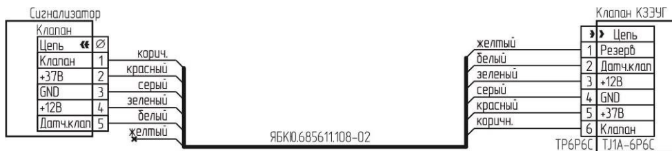
Рисунок В.4 – Схема подключения клапана КЗЭУГ с разъемом ТЛ1А-6P6C
