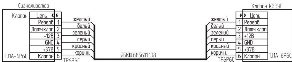
Рисунок В.2 – Маркировка кабеля с разъемом TP6P6C для клапана КЗЭУГ.
