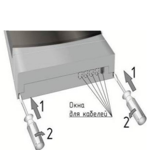
Рисунок 2 – Снятие крышки клеммного отсека
