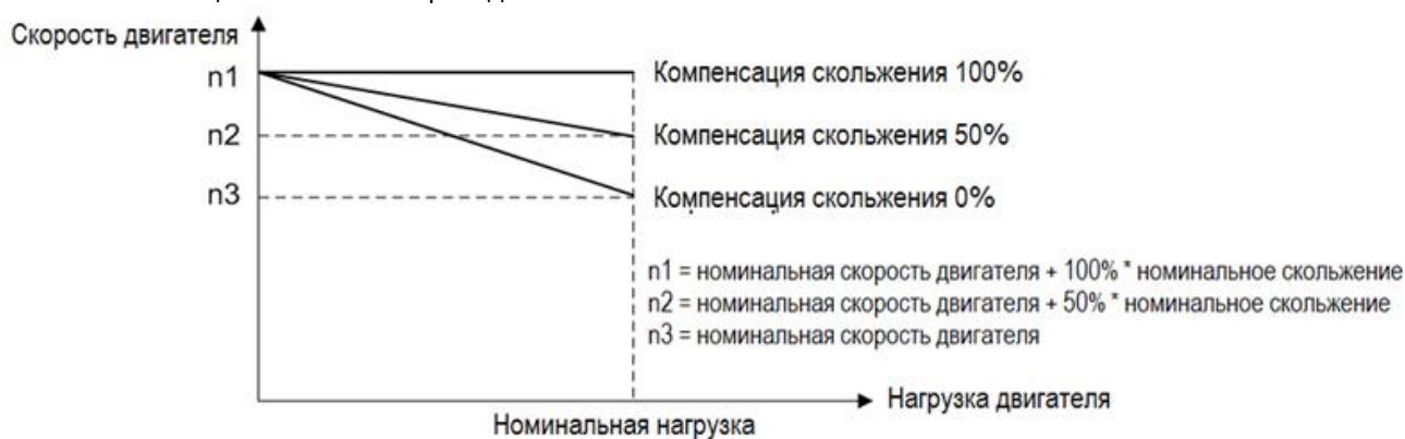
Компенсация скольжения в режиме вращения двигателя
