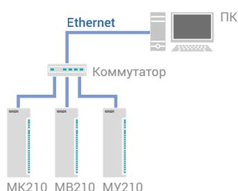
Удаленный ввод/вывод сигналов при подключении к SCADA-системам и другому ПО
