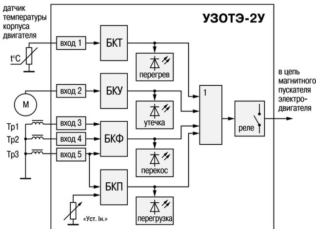
УЗОТЭ-2У включает в себя 4 блока контроля состояния электродвигателя:
