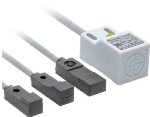
Применяются для сигнализации конечного или промежуточного положения металлического объекта в автоматических линиях, станках и т.п. Датчики серии LK предназначены для установки в ограниченном пространстве, а также в случаях, когда установка датчиков в цилиндрическом корпусе невозможна либо затруднена. Датчики реагируют на появление металлического предмета в зоне их действия.
