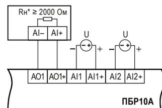
Подключение аналоговых входов/ выходов с сигналом типа напряжение
