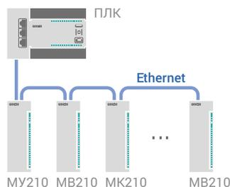
Увеличение числа входов/выходов любых модификаций ОВЕН ПЛК, СПК и СП с интерфейсом Ethernet
