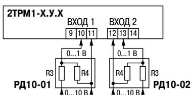
Предназначен для подключения датчиков с унифицированным выходным сигналом напряжения 0...10 В к измерительным приборам, воспринимающим унифицированный сигнал напряжения 0...1 В.
