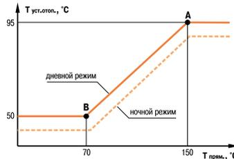
Пример отопительного графика —  $T_{уст.отоп.} = f(T_{прям.})$
