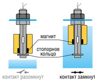
По достижении подвижным поплавком крайнего верхнего положения замыкается контакт геркона и происходит срабатывание (размыкание электрической цепи). При перемещении поплавка до крайнего нижнего положения контакты геркона размыкаются. Таким образом контролируется уровень жидкости в емкости.
