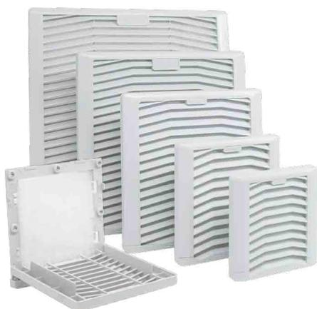
Выпускные решетки KIPVENT с фильтрами используются совместно с впускными решеткам KIPVENT с вентиляторами для обеспечения принудительной или естественной вентиляции шкафов управления. Оборудованы сменным фильтром, предотвращающим попадание пыли внутрь шкафа. Устанавливаются в боковую стенку или дверцу шкафа.
