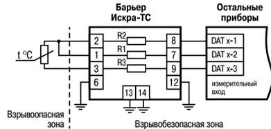
Подключение термосопротивления и барьера искрозащиты ИСКРА-ТС.03 к другим приборам
