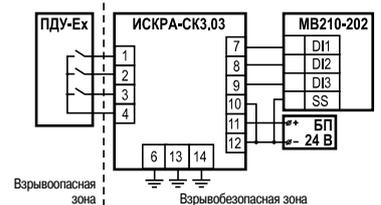
Подключение сигнализатора уровня ПДУ-3.3-Ex и барьера искрозащиты ИСКРА-СК3.03 к МВ210-202
