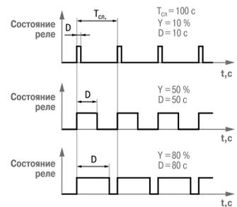
График сигналов на выходе ШИМ и ИМ при управлении средней скоростью регулирующего воздействия Y
