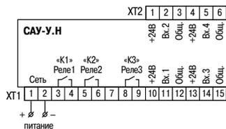
Схема подключения прибора в настенном корпусе Н
