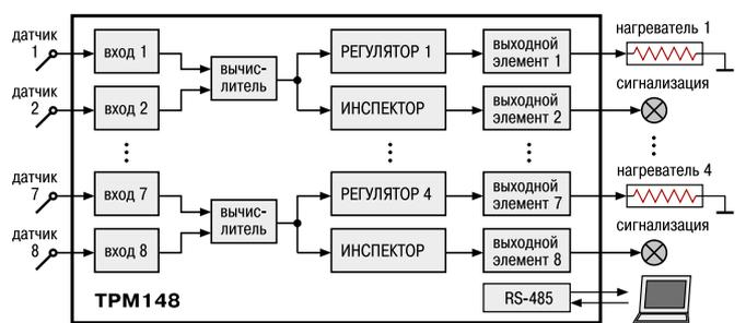
**Модификация 4.** 4 канала регулирования по ПИД- или ON/OFF-закону. Параллельно – контроль нахождения регулируемой величины в заданном диапазоне. Регулируемая величина может быть вычислена по результатам измерений одного или двух входов.
