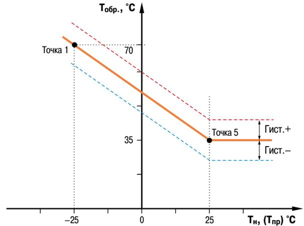
Если  $T_{обр.г} > (T_{обр.г} \text{ по графику} + \text{«Гист.+»})$  (режим **ОБРАТНАЯ** при работе с ТЭЦ), то прибор подает команды на прикрытие регулирующего клапана.
