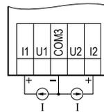
Подключение активных датчиков с выходом «Ток 4...20 мА»
