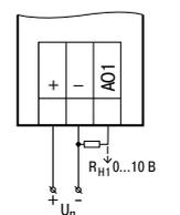
Подключение к аналоговому выходу нагрузки в виде напряжения
