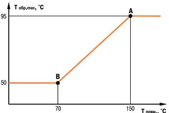
Пример графика температуры обратной воды —  $T_{обр.мах} = f(T_{прям.})$
