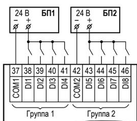
Подключение дискретных датчиков с питанием =24 В (для модификаций ПР100-24)
