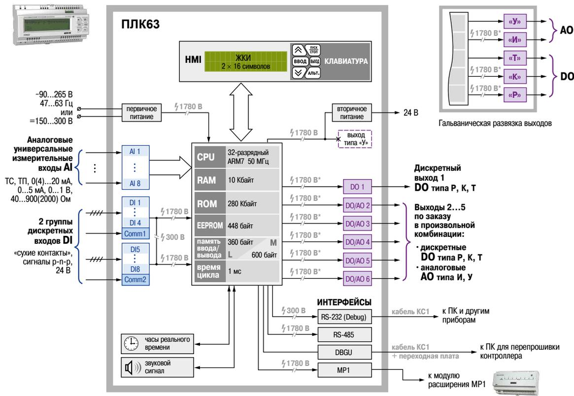
**Линейка контроллеров с встроенными средствами человеко-машинного интерфейса.**
