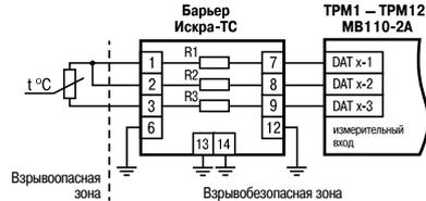
Подключение термосопротивления и барьера искрозащиты ИСКРА-ТС.03 к приборам ОВЕН ТРМ1-ТРМ12, МВ110-2А
