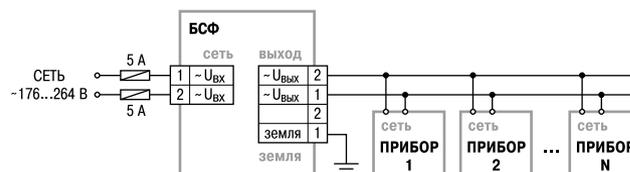
1. Не допускается параллельная работа блоков сетевого фильтра.
