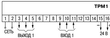
Схема расположения и назначение клемм ТРМ1
