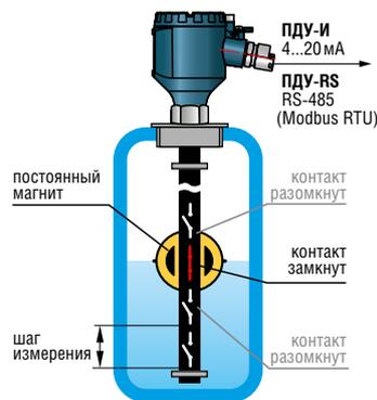
Поплавок с постоянным магнитом перемещается вместе с уровнем жидкости по штоку, в котором находится матрица герконов и сопротивлений. Под воздействием магнитного поля происходит срабатывание герконов, цепь работает по схеме трёхпроводного потенциометра. При изменении уровня жидкости изменяется выходное сопротивление датчика, преобразуемое в стандартный сигнал 4...20 мА или в код, передаваемый по сети RS-485 (Modbus RTU). Выходной сигнал датчика пропорционален уровню жидкости.
