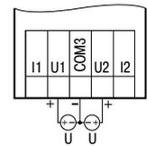
Подключение активных датчиков с выходом «Напряжение 0...10 В»
