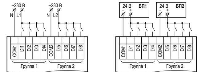
Подключение датчиков типа «сухой контакт» для сигналов =24 В
