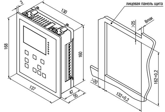
Габаритный чертеж ПЛК73 в корпусе щитового крепления
