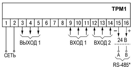
Схема расположения и назначение клемм ТРМ1
