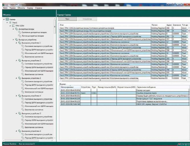
Owen OPC Server применяется для работы с устройствами OVEN. Программа содержит готовую библиотеку оборудования OVEN, что сокращает время настройки устройств в OPC-сервере. Возможность работы с оборудованием других производителей, поддерживающих обмен по протоколу Modbus RTU/ASCII и Modbus TCP.
