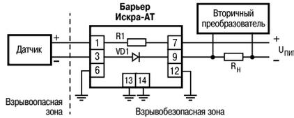
Подключение датчика с сигналом 4...20 мА и барьера искрозащиты ИСКРА-АТ.03
