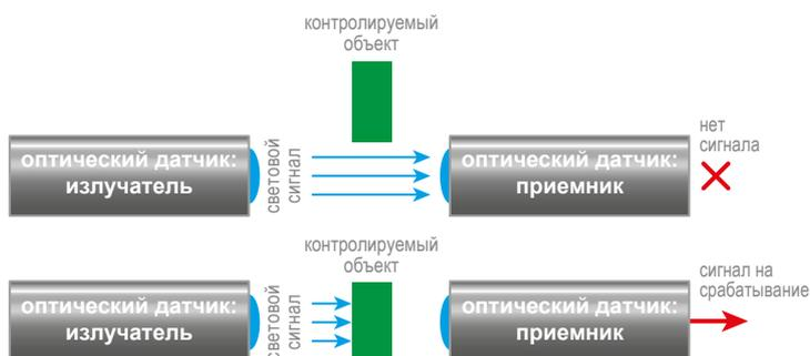
Принцип действия оптических бесконтактных датчиков основан на изменении принимаемого датчиком светового потока. Оптические датчики состоят из 2-х функционально законченных узлов – излучателя и приемника излучения, которые могут быть выполнены в одном корпусе или в разных корпусах.
