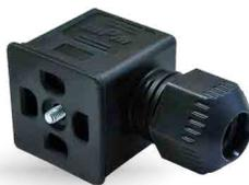
Электроразъём РК-1 (С28300N0R) – электрический соединитель стандарта EN 175301-803 A (DIN 43650A), широко применяется в промышленности в качестве основного разъема для коммутации кабеля с любым датчиком давления, уровня и различных приборов. Способствует снижению попадания влаги и окисления контактов коммутации информационных линий.
