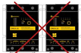
Монтаж прибора необходимо производить в вертикальном положении с сохранением необходимого зазора между соседними приборами (вертикальный зазор не менее 150 мм, горизонтальный – не менее 50 мм). Монтаж приборов вплотную и в горизонтальном положении не допускается.
