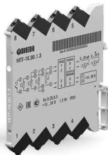
Устройство объединяет в одном компактном корпусе барьер искрозащиты и нормирующий преобразователь. Преимуществом этого типа барьеров искробезопасности является наличие гальванической развязки, благодаря чему не требуется заземление, а надежность системы и «помехоустойчивость» повышается.
