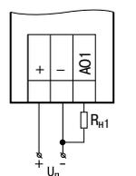
Подключение к аналоговому выходу токовой нагрузки
