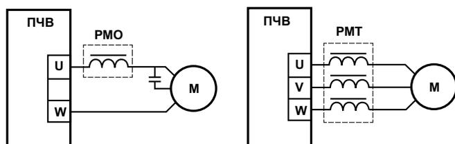
Моторные дроссели устанавливаются после преобразователя частоты и предназначены для повышения качества выходного напряжения ОВЕН ПЧВ и защиты его от импульсов напряжения и скоротечных коротких замыканий на двигателях.
