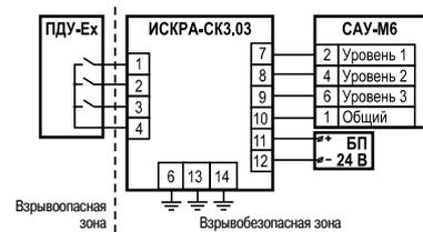
Подключение сигнализатора уровня ПДУ-3.3-Ex и барьера искрозащиты ИСКРА-СК3.03 к САУ-М6
