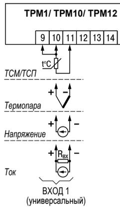
**СХЕМЫ ПОДКЛЮЧЕНИЯ ВЫХОДОВ ТРМ1Х**
