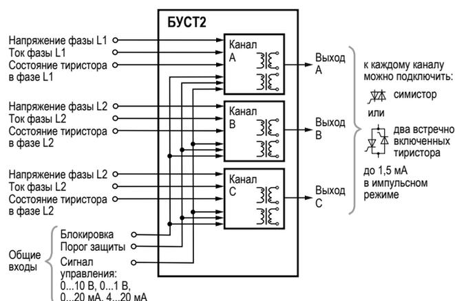
Предназначен для управления симисторами или тиристорами, работающими с активной или активно-индуктивной нагрузкой: нагревательными элементами печей, инфракрасными лампами, трансформаторами, двигателями и др.
