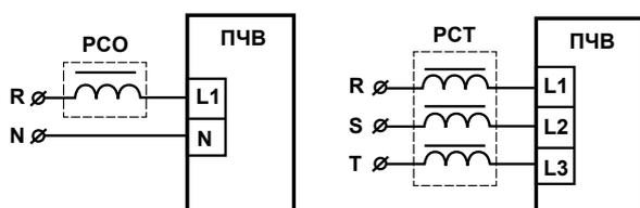
Сетевые дроссели (реакторы) устанавливаются в силовых цепях питания преобразователей частоты для снижения взаимного вредного влияния ПЧВ и сети.
