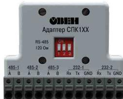
**Адаптер СПК1ХХ** – переходник с разъемов DB9 на пружинные зажимные клеммы. Имеет встроенные согласующие резисторы 120 Ом, подключаемые с помощью DIP-переключателей. Входит в комплект поставки.
