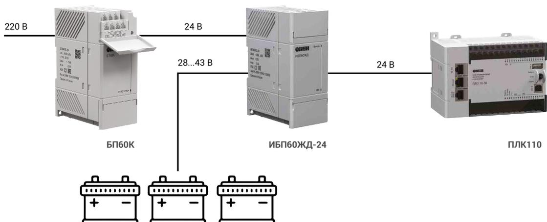
Резервирование питания станционной автоматики ЖД станций
