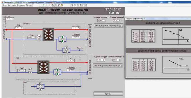
Применяется для создания локальных проектов автоматизации и проектов с различной сетевой архитектурой. Серверы Телемеханика ЛАЙТ и АРМ Телемеханика ЛАЙТ обмениваются информацией в режиме «клиент-сервер». В качестве источника информации для SCADA могут выступать серверы OPC DA, устройства с протоколом Modbus, счетчики электроэнергии, контроллеры ОВЕН, в том числе и под управлением исполнительной системы EnLogic.
