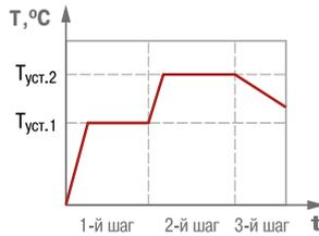
**Использование ТРМ151-04 при термообработке керамики для регулирования температуры в камере, с возможностью аварийной сигнализации** ПИД-регулирование температуры осуществляется с помощью ТЭНа. Программа регулирования состоит из 3-х шагов, каждый с заданной длительностью: 1-й шаг — нагрев и выдержка при температуре  $T_{уст.1}$ , 2-й шаг — то же при  $T_{уст.2}$ , 3-й шаг — охлаждение. Второе реле прибора используется для аварийной сигнализации, например, при перегреве.
