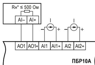
Подключение аналоговых входов/ выходов с сигналом типа ток
