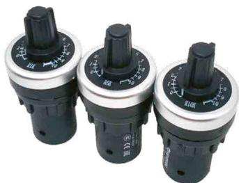
Потенциометры – это переменные резисторы, применяемые для регулировки различных технологических параметров. Одно из основных применений – удаленное управление скоростью вращения электродвигателя через аналоговый вход преобразователя частоты. Потенциометры могут также применяться для регулирования температурного режима, изменения значений напряжения, установки таймера реле времени, регулировки выходного напряжения ТТР.
