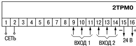
Схема расположения и назначение клемм 2ТРМ0
