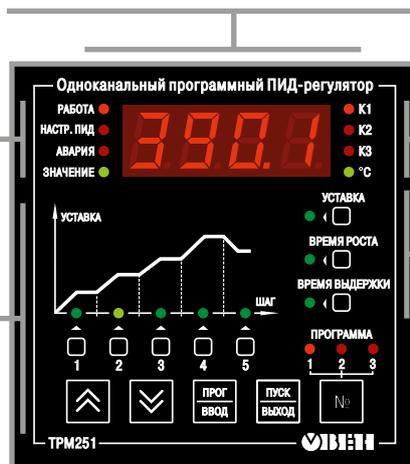
Для контроля работы выходных элементов предназначены светодиоды «K1», «K2», «K3».
