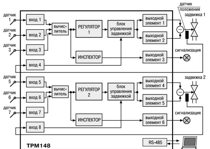
**Модификация 6.** 2 канала регулирования 3-позиционными ИМ (задвижками, заслонками, жалюзи и т. д.). Регулируемая величина может быть вычислена по результатам измерений трех входов. Имеется вход для подключения датчика положения. В каждом канале осуществляется контроль нахождения регулируемой величины в заданном диапазоне.
