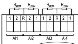
Подключение термометров сопротивления
