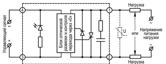
Схема включения ТТР серии HDH-xx44.ZD3 (выход – SCR-тиристор)
