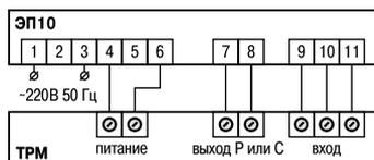
Предназначен для проведения экспериментов в процессе наладочных работ с применением терморегуляторов. ЭП10 выступает в качестве объекта управления и представляет собой миниатюрную печь.
