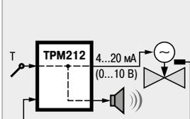
ПИД-регулирование с помощью задвижки с аналоговым управлением
