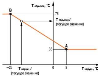
Пример графика температуры обратной воды —  $T_{обр.мах} = f(T_{наруж.})$
