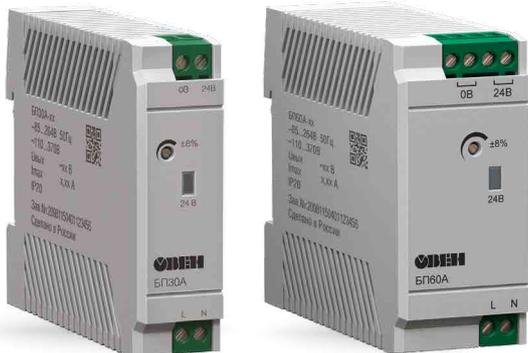
Предназначены для питания стабилизированным напряжением 12 или 24 В приборов и датчиков. Рекомендуются к применению в шкафах автоматики, где требуется компактное по ширине решение: БП30А, БП30А-С – 22 мм, БП60А, БП60А-С – 35 мм.
