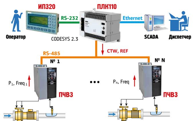
изменяемые параметры ПЧВ доступны для изменения по интерфейсу. Такой подход упрощает интеграцию ПЧВ в систему удаленного управления и диспетчеризации любой сложности.
