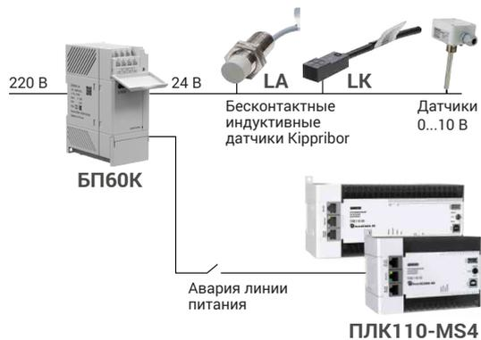
Сигнализация наличия питания для датчиков и актуаторов в ответственных применениях
