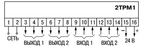
Схема расположения и назначение клемм 2ТРМ1
