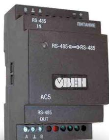
Предназначен для построения промышленных информационных сетей RS-485. Позволяет увеличивать физическую длину линии связи и число приборов в сети.
