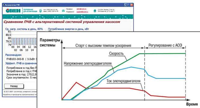
Предназначены для управления приводами на базе асинхронных двигателей в системах холодного и горячего водоснабжения, канализации, вентиляции, дымоходов, градирен, чиллеров, вспомогательного оборудования котельных, ТЭС, ТЭЦ и т.п. В линейке сохранены и расширены возможности общепромышленных применений (смесители, дозаторы, ременные приводы, конвейеры и т.п.).
