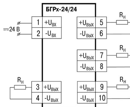
**Внимание!** Питание блока следует осуществлять от локального источника питания подходящей мощности, например: ОВЕН БПО7, БП15 и др., установленного в том же шкафу электрооборудования, в котором устанавливается блок.
