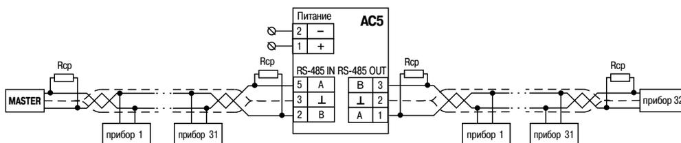
Подключение AC5 добавляет к сети RS-485 еще один сегмент с количеством приборов до 32 и длиной до 1,2 км. Начало сегмента – в месте подключения повторителя.
