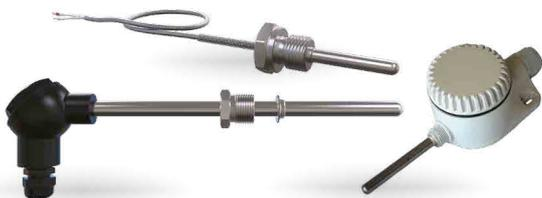
Принцип действия термопреобразователей сопротивления основан на свойстве проводника менять электрическое сопротивление пропорционально изменению температуры окружающей среды (ГОСТ Р 6651-2009). Конструктивно такие термопреобразователи выполняются в виде катушки из тонкой медной или платиновой проволоки на каркасе из изоляционного материала или используются тонкопленочные чувствительные элементы, заключенные в защитную гильзу.
