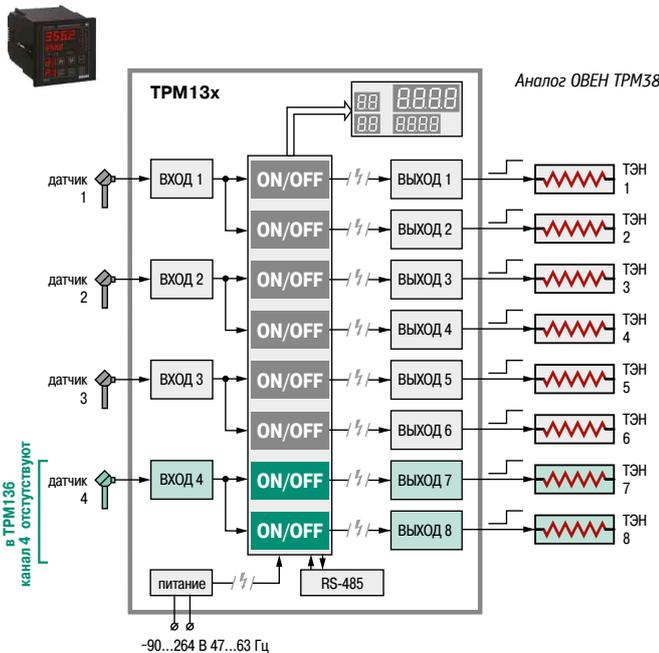
3- или 4-канальный трехпозиционный регулятор, может использоваться для контроля температуры и двухступенчатого управления процессом нагрева в технологическом оборудовании, содержащем до четырех зон нагрева и требующем быстрого разогрева при начале работы (в хлебопекарных печах, термопластавтоматах, экструдерах и др.).
