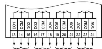
Подключение нагрузки к ВЭ типа Р – электромагнитное реле
