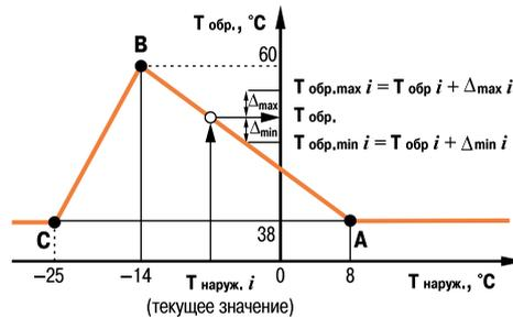
Пример графика температуры обратной воды —  $T_{обр.} = f(T_{наруж.})$
