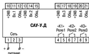
Схема подключения прибора в DIN-реечном корпусе Д
