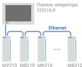
Для работы с любым оборудованием, поддерживающим интерфейс Ethernet и протоколы обмена Modbus TCP, SNMP, MQTT
