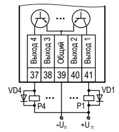
Подключение дискретных выходов типа К PR200-х.5, PR200-220.25
