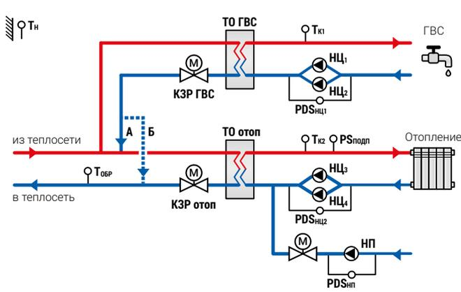
**Двухступенчатая ГВС + Отопление**
