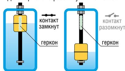
Датчик уровня имеет поплавок, передвигающийся по вертикальному штоку. Внутри поплавок находится постоянный магнит, а в штоке, представляющем собой полую трубку, находится геркон. Герконовый контакт срабатывает при приближении магнита.
