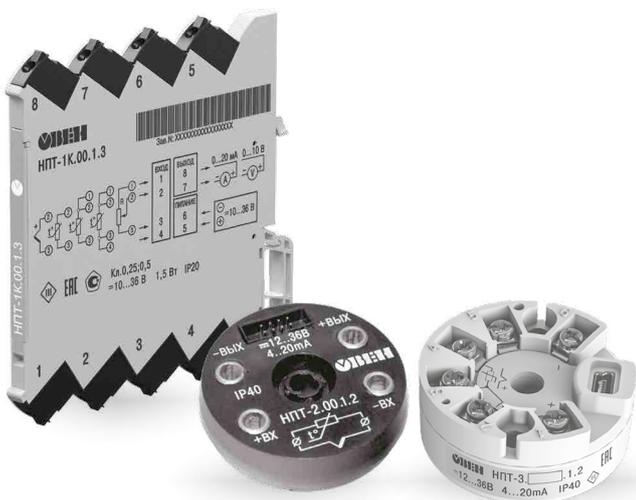
Нормирующие преобразователи ОВЕН НПТ преобразуют сигналы термометров сопротивления и термопар в унифицированные сигналы тока и напряжения: 0(4)...20 мА, 0...5 мА, 0(2)...10 В, 0...5 В. Повышают помехоустойчивость полевых линий связи, позволяют увеличить длину соединительных проводов, передать измеряемую температуру на несколько контроллеров или приборов.
