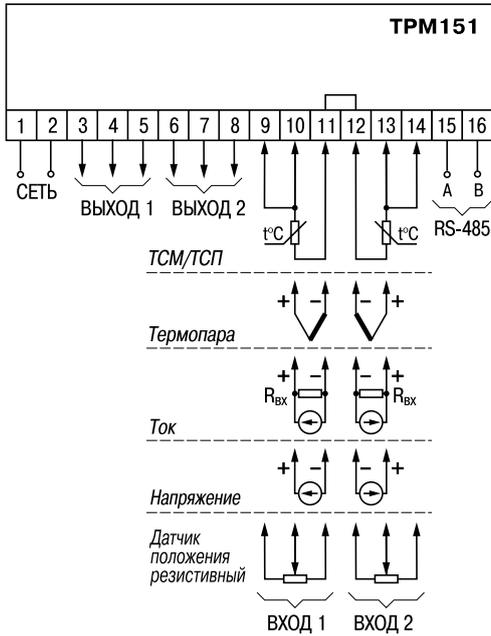
**СХЕМЫ ПОДКЛЮЧЕНИЯ ВЫХОДНЫХ ЭЛЕМЕНТОВ**
