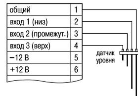
Подключение кондуктометрических датчиков уровня
