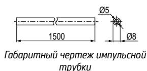
Габаритный чертеж импульсной трубки
