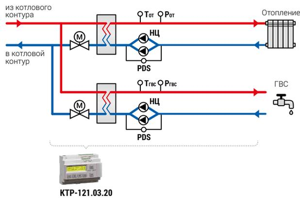
**Два контура отопления без подпитки**
