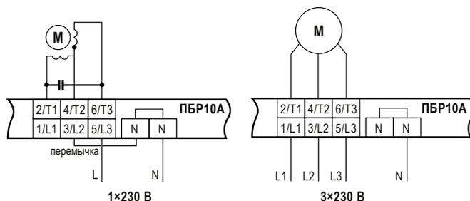
Подключение силовых клеммников при работе с однофазным двигателем
