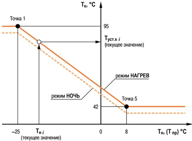
**Снижение отопительного графика по встроенным часам реального времени**
