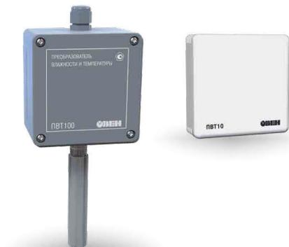
Датчики влажности и температуры ОВЕН ПВТ предназначены для непрерывного преобразования относительной влажности и температуры неагрессивного газа в два унифицированных выходных сигнала 4...20 мА и RS-485.
