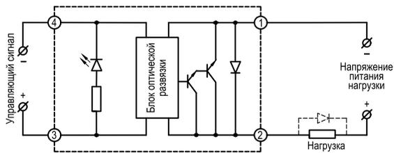
Схема включения ТТР серии HD-xx25.DD3
