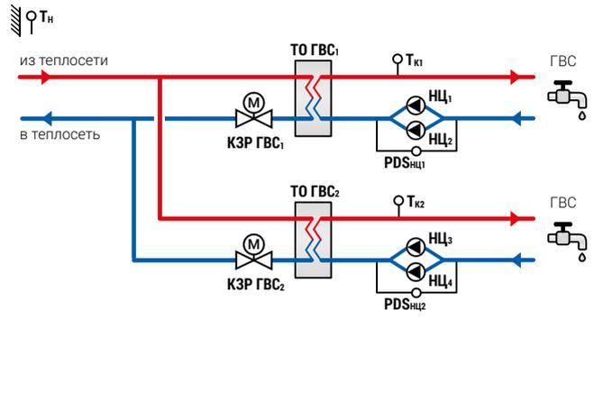
**Одноступенчатая ГВС + Отопление**
