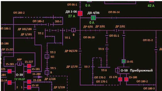
Редакция «ССПИ» (Система сбора и передачи информации) отличается от редакции «Базовая» наличием протоколов приема данных телемеханики МЭК 60870-5-101/103/104, DNP3, встроенной опцией передачи данных от сервера Телемеханика ЛАЙТ по протоколу МЭК 60870-5-104.
