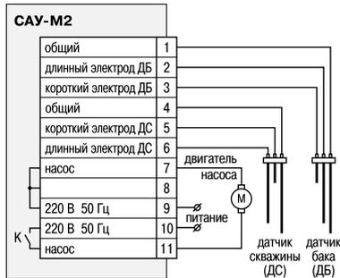
Заполнение резервуара с помощью погружного насоса с защитой от «сухого» хода. При работе без защиты от «сухого» хода на клеммы 4,5,6 ставится перемычка.
