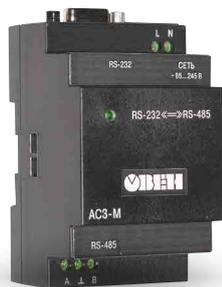
Предназначен для взаимного преобразования сигналов интерфейсов RS-232 и RS-485. Позволяет подключать к промышленной информационной сети RS-485 устройство с интерфейсом RS-232 (персональный компьютер, считыватель штрих-кодов, электронные весы и т. д.).
