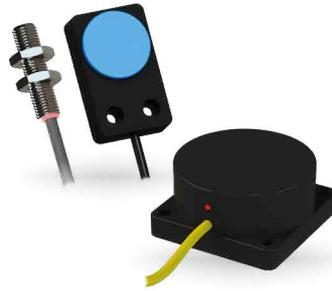
Предназначены для бесконтактного обнаружения и подсчета различных объектов, находящихся в зоне их чувствительности. В отличие от емкостных датчиков, индуктивные реагируют только на металлы и не чувствительны к остальным материалам, что исключает риск ложного срабатывания (например от рук оператора, эмульсии, воды, смазки и т.п.).
