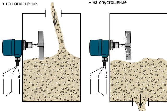
Принцип действия ротационного сигнализатора основан на возникновении реактивного момента мотора, встроенного в корпус датчика. Датчик оснащен лопастями, которые вращаются со скоростью 1 об/мин. Когда продукт достигает уровня лопастей, он блокирует их вращение. На валу двигателя создается реактивный момент, из-за чего срабатывает микровыключатель (реле) выходной цепи сигнализатора.
