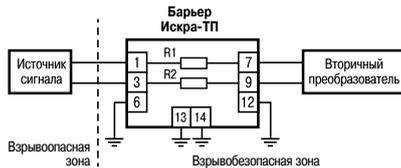
Подключение термопары и барьера искрозащиты ИСКРА-ТП.03
