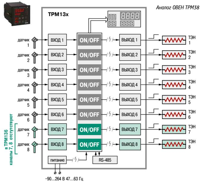
6- или 8-канальный регулятор температуры либо другой физической величины, может использоваться в многозонных печах туннельного типа, в хлебопекарном производстве и другом технологическом оборудовании.
