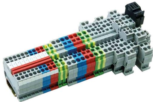
Предназначены для упрощения подключения проводников в шкафах автоматизации, управления и распределения электроэнергии. Клеммы обеспечивают безопасное и надежное соединение проводников сечением от 2,5 до 4 мм<sup>2</sup>. Применение пружинных клемм по сравнению с винтовыми позволяет сократить время монтажа – достаточно установить отвертку в контактную колодку и подключить проводник.
