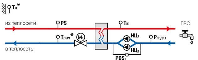
\* Датчики  $T_n$  и  $T_{обр}$  подключают, если необходима функция контроля температуры обратной воды (по умолчанию в контуре ГВС функция отключена).
