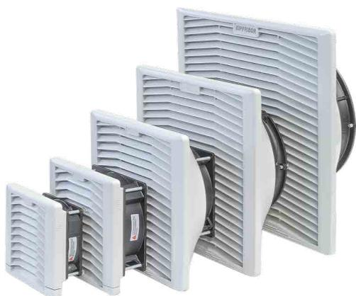
Впускные решетки KIPVENT с вентиляторами предназначены для врезки в боковую стенку или дверцу шкафа управления для обеспечения принудительной циркуляции воздуха внутри оболочки шкафа. Управление принудительной циркуляцией воздуха позволяет поддерживать в шкафу управления оптимальный для оборудования микроклимат. Оборудованы сменным фильтром, предотвращающим попадание пыли внутрь шкафа. Рекомендуется использовать совместно с выпускными решетками KIPVENT.
