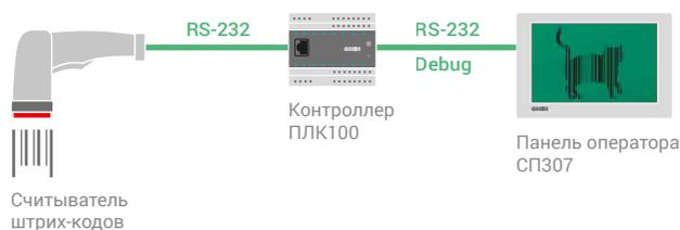
Подключение внешних устройств с нестандартными протоколами (например, считывателя штрих-кодов)
