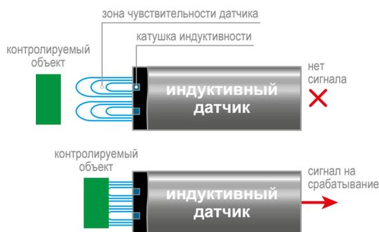
Принцип действия индуктивных бесконтактных датчиков основан на изменении параметров магнитного поля катушки индуктивности, в зону которой попадает металлический объект. При подаче питания перед активной зоной датчика, представляющей собой катушку индуктивности, возникает магнитное поле, которое является зоной чувствительности датчика. При внесении в эту зону металлического объекта изменяются параметры поля катушки и состояние выхода датчика.
