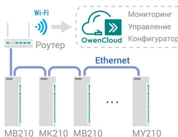
Контроль работы приборов и управление ими в облачном сервисе OwenCloud. Автоматическое оповещение о настраиваемых аварийных событиях по электронной почте и push-уведомления в мобильном приложении
