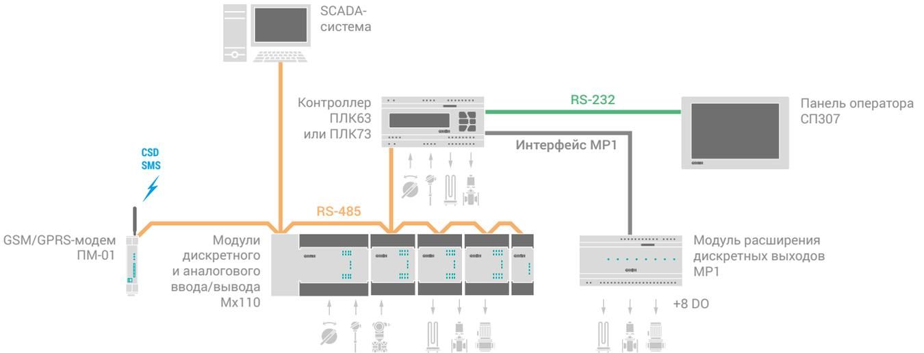
**ФУНКЦИОНАЛЬНАЯ СХЕМА ПЛК73**
