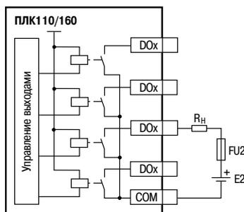
Схема подключения выходных элементов типа Р с внешними цепями защиты
