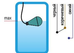
Подвесной сигнализатор уровня содержит герметично закрытый микропереключатель. При погружении поплавка в жидкость датчик наклоняется, что вызывает срабатывание микропереключателя, который включает/останавливает исполнительный механизм (насос, вентиль и др.).
