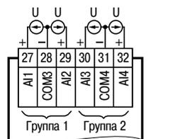
Подключение активных датчиков с выходом «напряжение 0...10 В»
