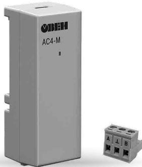
Предназначен для взаимного преобразования сигналов интерфейсов USB и RS-485 с обеспечением гальванической изоляции. Позволяет подключать к промышленной сети RS-485 персональный компьютер, имеющий USB-порт.
