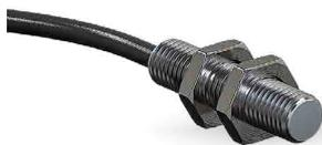
Индуктивные датчики PS2 являются усовершенствованным аналогом датчиков ВБ2 и предназначены для бесконтактного обнаружения и подсчета различных объектов, находящихся в зоне их чувствительности. В отличие от емкостных датчиков, индуктивные реагируют только на металлы и не чувствительны к остальным материалам, что исключает риск ложного срабатывания (например от рук оператора, эмульсии, воды, смазки и т.п.).
