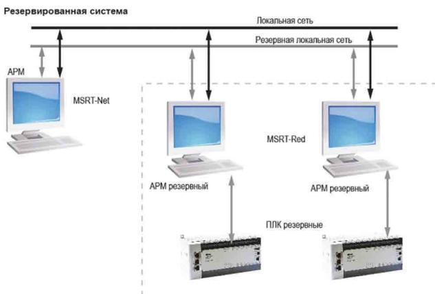
Непосредственно исполнительная система **MasterSCADA**. В ней производится опрос, визуализация и архивирование параметров. Исполнительная система двух типов: **MSRT-NET** и **MSRT-NET PRO**. Необходимая версия выбирается по количеству внешних точек и поддерживаемым функциям (см. табл.).
