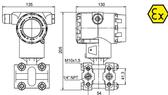
Предназначены для измерения перепада давления на промышленных объектах и объектах ЖКХ в различных системах автоматического контроля, регулирования и управления технологическими процессами: расход на сужающих устройствах (имеется корневизвлекающая функция), измерение уровня в герметичных емкостях под давлением и т.п.
