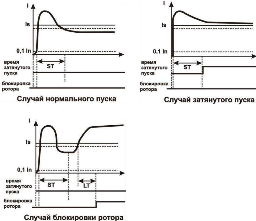
Рисунок 1.4 - Затянутый пуск и блокировка ротора
