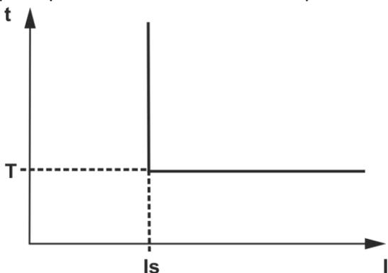
Рисунок 1.2 - Принцип защиты с независимой выдержкой времени
