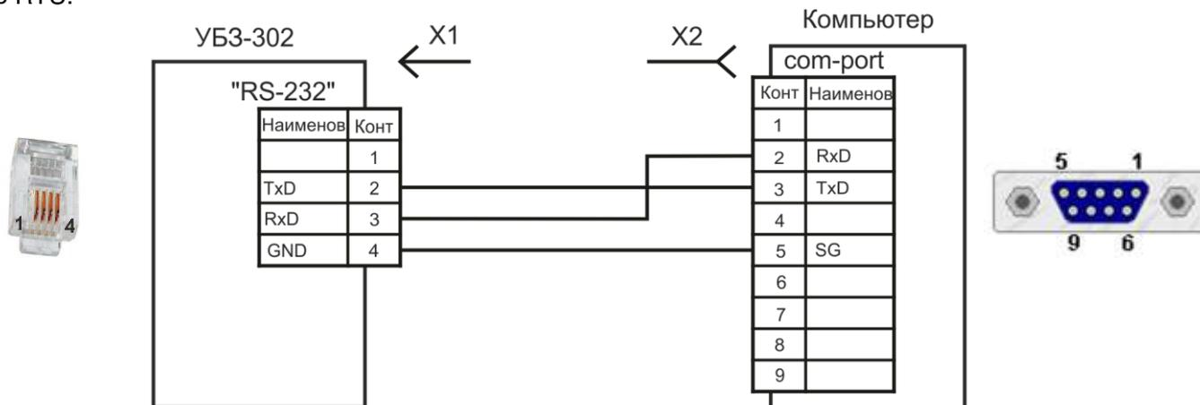
X1 Вилка для подключения телефонной трубки PLUG-4P4C-P-C2
