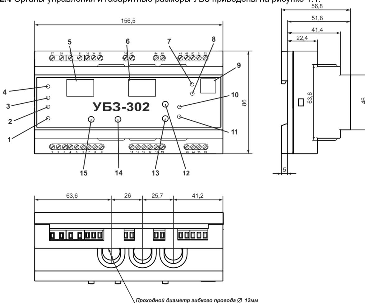
Рисунок 1.1 - Органы управления и габаритные размеры УБЗ
