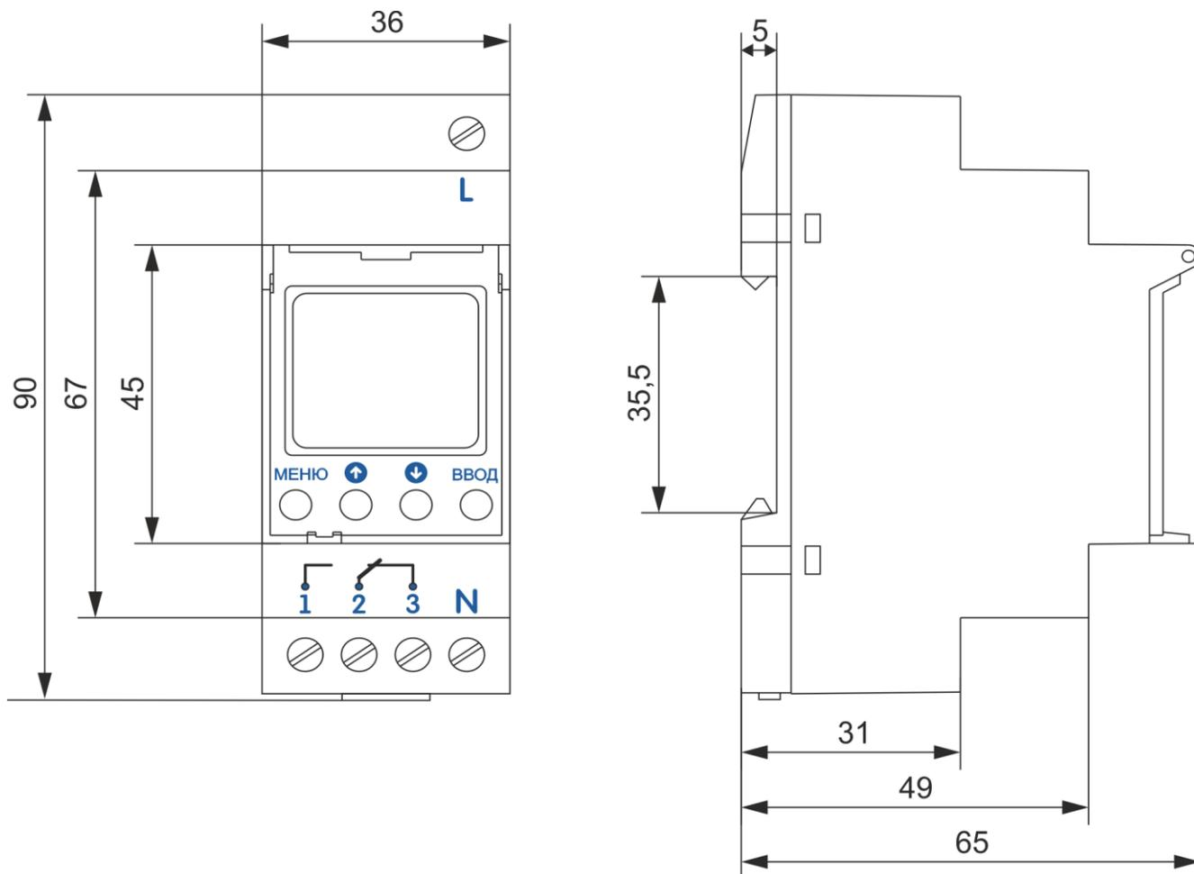
Рисунок 1 – Внешний вид и габаритные размеры РЭВ-225
