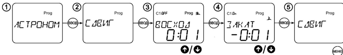
Рисунок 7 – Схема настройки смещения времени
