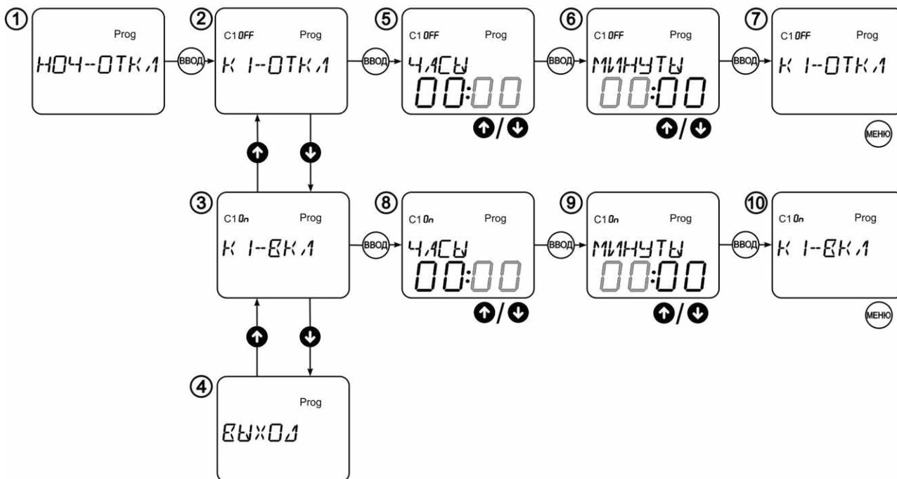
Рисунок 13 – Схема настройки режима «Ночной перерыв»
