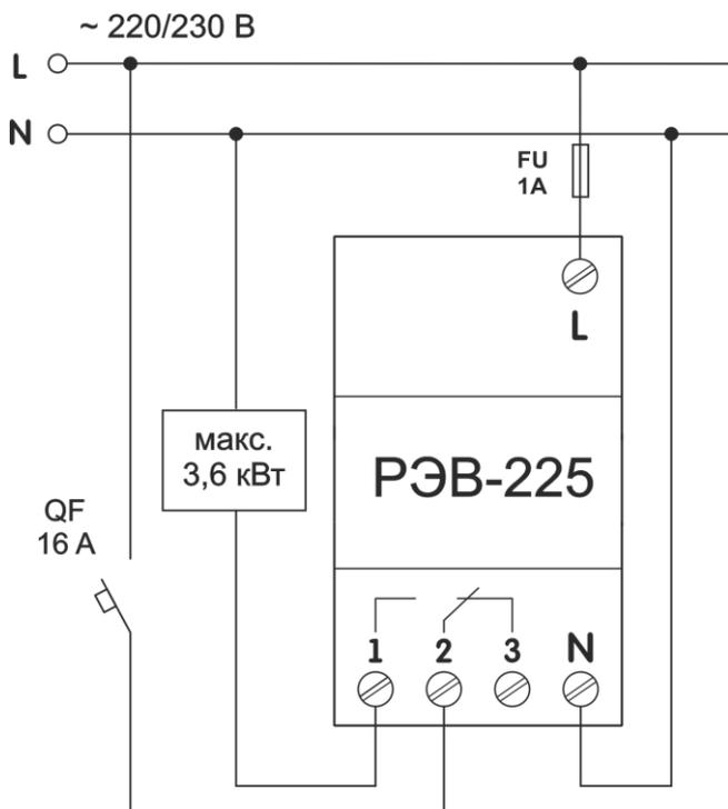
QF – автоматический выключатель на ток 16 А класса В;
