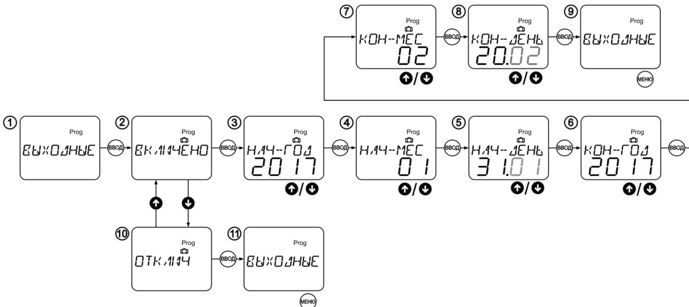
Рисунок 12 – Схема настройки режима «Выходные дни»
