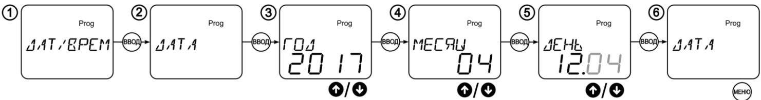
Рисунок 10 – Схема настройки даты
