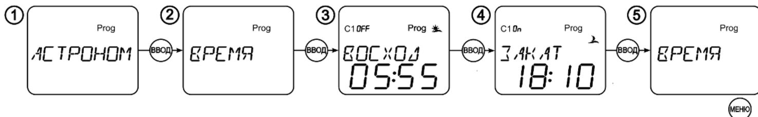
Рисунок 6 - Схема просмотра астрономического времени
